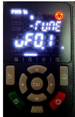
3.1.3.2 – Visualizada a descrição “TUNE” na consola é necessário dar uma ordem de subida ou descida ao variador (entrada DI1 ou DI2). Nesse momento o variador inicia o processo de auto-tuning,
